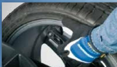
Les techniciens n'ont qu'à toucher la jante avec le bras de jauge pour que le système saisisse automatiquement les dimensions de la jante et sélectionne le mode d'équilibrage approprié.
