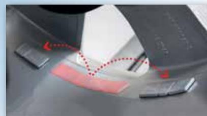
Équilibrage précis et dissimulation discrète des masses derrière les rayons, préservant ainsi l'attrait esthétique et la présentation visuelle de la roue.
